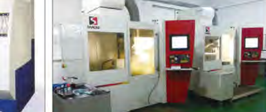
德国 SAACKE UWIF5 轴 5 联动数控刀具磨床
